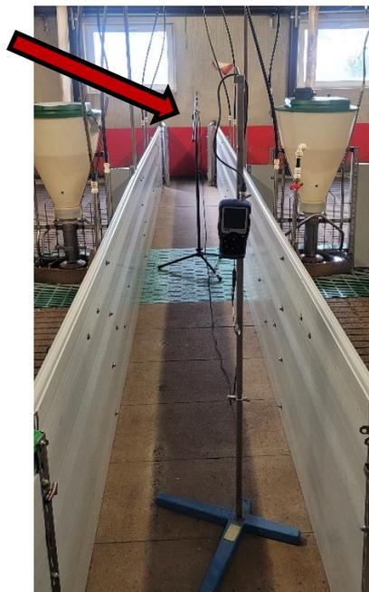
Abb. 3: Position des Mikrofons in einem Abteil zur Messung des Grundscharpegels.
