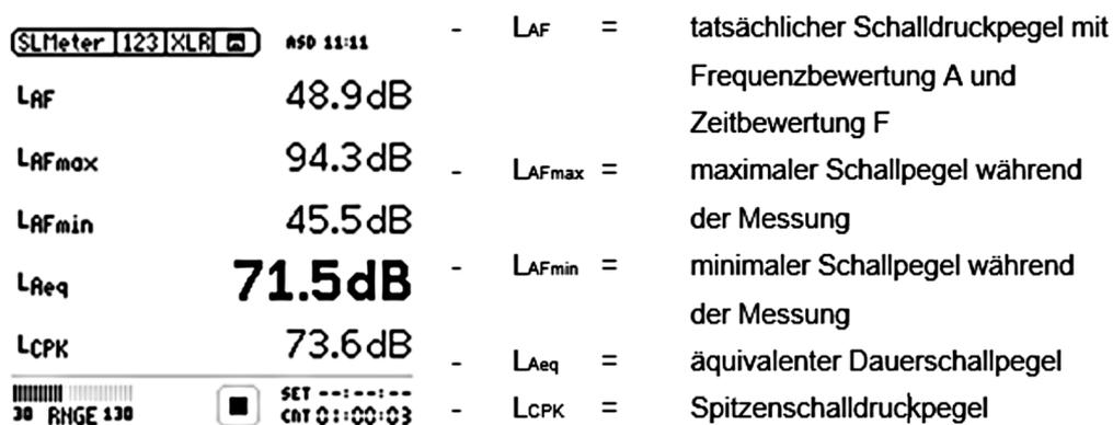
Abb. 1: Beispielhaft ermittelte Messwerte in der Anzeige des Audio- und Akustik-Analyzers NTI Audio XL 2 M4261, NTI Audio, Schaan, Liechtenstein und zugehörige Definitionen.
