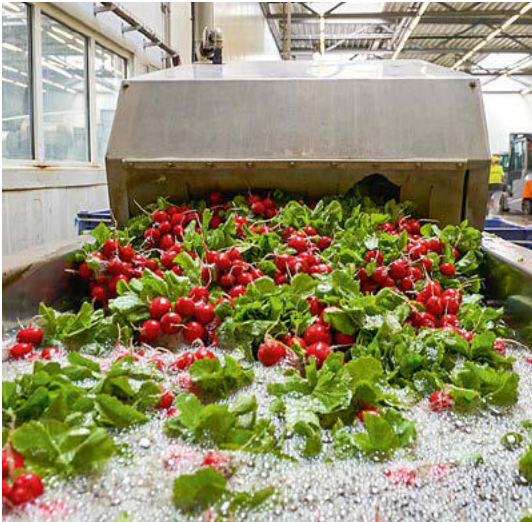
Eine Wasseraufbereitungsanlage speist die Waschstraße für Radieschen.
