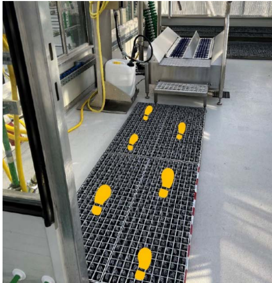
Abb. 2: Aufbau der mit ProfilGate® i55 go Gitterrosten mit Bürstenleisten erweiterten Hygieneschleuse sowie Schrittfolge auf den vorderen Gitterrosten bei den Versuchen
