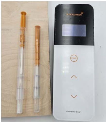
Abb. 6: ATP-Lumitester von Kikkoman mit Teststäbchen (ATP-Pen) zum Beprobieren der Schuhsohlen
