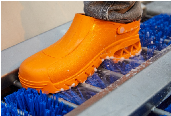
Abb. 1: Schuhreinigung und -desinfektion mit rotierenden Bürsten in der Hygieneschleuse
