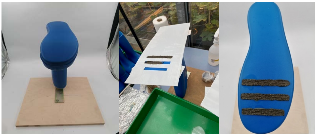
Abb. 2: Kontamination ausgewählter Flächen auf glatten Sohlen. Links: Einspannen der Testschuhe auf der Halterung, Mitte: Aufsetzen der Schablone, Rechts: In drei Streifen aufgetragene Standardverschmutzung auf den glatten Sohlen
