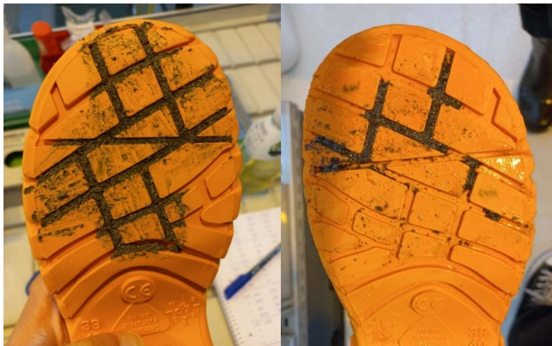
Abb. 3: Mit Standardverschmutzung kontaminierte Arbeitsschuhe vor (links) und nach (rechts) der Behandlung in der Hygieneschleuse
