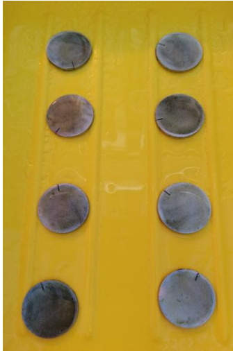
Abb. 12: Prüfträger aus Edelstahl, kontaminiert mit einem TMV-infizierten Pflanzenhomogenat
